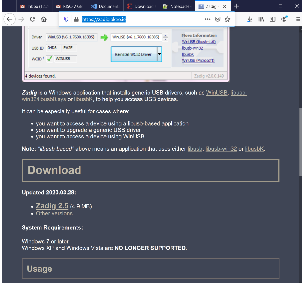
Figür 96. PlatformIO'nun kullandığı Nexys A7 kart sürücüsünü kur
